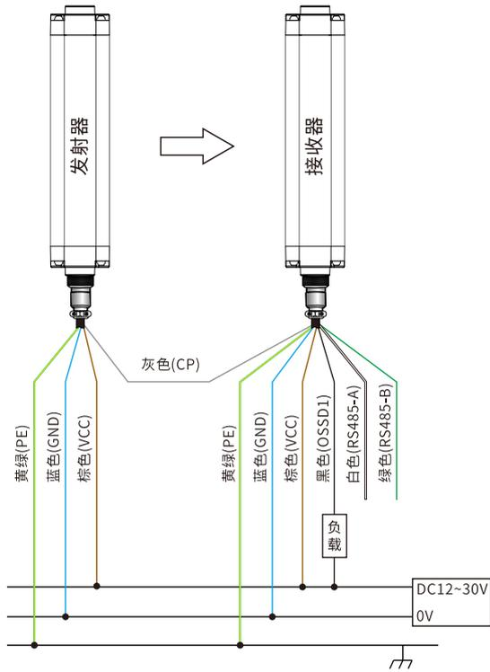
PNP开关量输出+RS485输出方式(ELG外壳)
