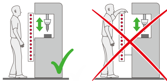
左侧正确：不能从上方到达保护区域 右侧错误：能从上方到达保护区域
