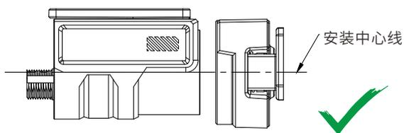
1、安装正确，门锁主体和匹配器感应面相对
